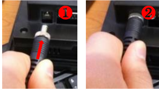
<그림 1-3> DC 어댑터 전원 연결 모습
