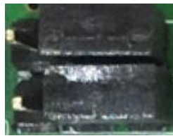
<그림 3-3> COM4, COM5 설정을 위한 Jumper 의 모습
